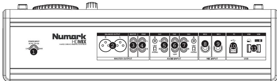
1. **Power** – Bitte schließen Sie das mitgelieferte Netzteil (DC 12V 2A) hier an und verbinden Sie es mit einer Stromquelle. Verwenden Sie bitte *ausschließlich* das mitgelieferte Netzteil – der Einsatz eines alternativen Netzteils könnte Ihrem HDMIX beschädigen.
