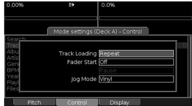
**FADER START:** Configure la función de fader start si hay un mezclador compatible conectado.
