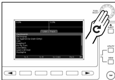
Si l'élément en évidence est sélectionnable, poussez simplement le bouton Push Select. Les autres options apparentées à la liste ou à l'élément actuellement en évidence peuvent s'afficher dans la barre du menu.
