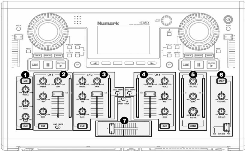
1. **CANAL MICRO** – Ce canal est doté des commandes suivantes, qui permettent de modifier le signal d'entrée Mic 1. Veuillez noter que le signal microphone n'est pas acheminé au potentiomètre et sera envoyé directement au mix principal.
