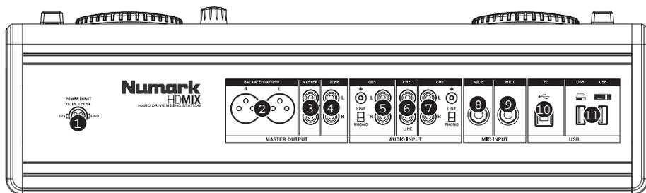
1. **Alimentazione** – Inserire l'adattatore di alimentazione in dotazione (CC 12V 2A) e collegarlo ad una sorgente di alimentazione. Servirsi *unicamente* dell'adattatore in dotazione: l'uso di un adattatore diverso può danneggiare l'HD MIX.
