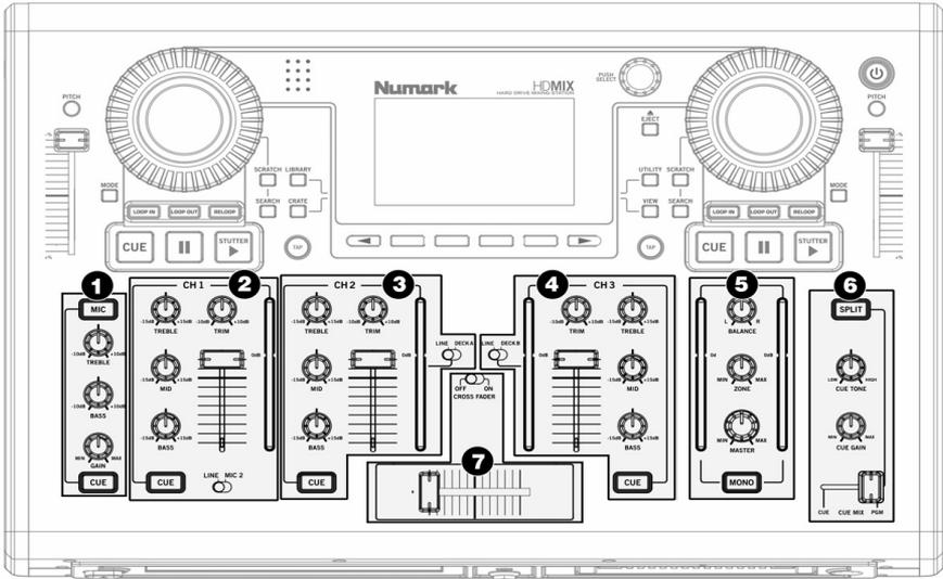
1. **MIKROFON KANAL** – Dieser Kanal besitzt die folgenden Bedienelemente, die das Mic 1 Eingangssignal beeinflussen. Beachten Sie bitte, dass das Mikrofonsignal nicht zum Crossfader geführt, sondern direkt zum Master Mix gesendet wird.
