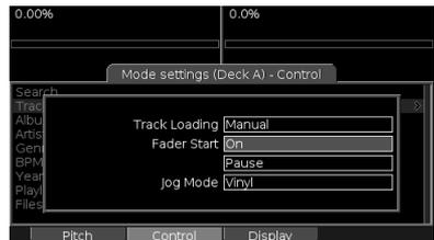
**Nota técnica:** El sistema HDMIX usa el método ampliamente soportado 5V Pulse de señalización de fader start. Para la instalación del cable, consulte la sección "Diagrama de conexiones" de este manual. Consulte el manual de su mezclador para verificar la compatibilidad.
