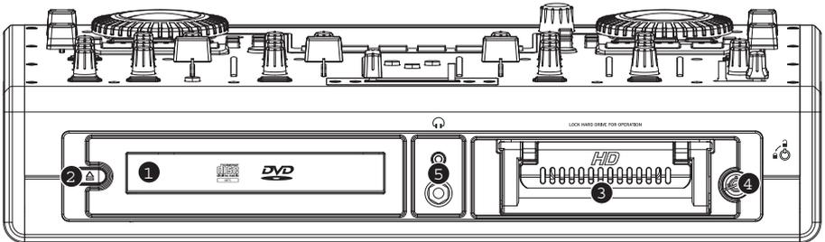
1. **CD/DVD Laufwerk** – Legen Sie in dieses Laufwerk CD/DVD Discs ein. Es erkennt sowohl Audio CDs als auch Daten CDs/DVDs (solange die Daten in einem kompatiblen Format darauf gespeichert wurden). Weitere Hinweise finden Sie im Abschnitt "Formate".
