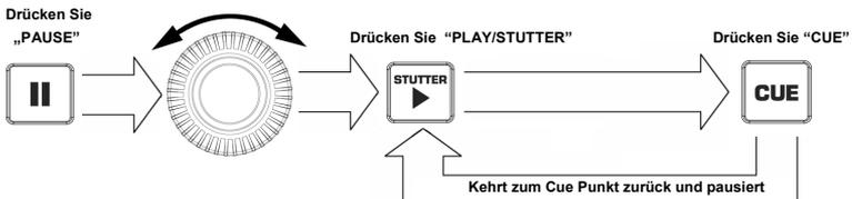
4. **JOG WHEEL** – Dieses Rad können Sie für Pitch Bend-Funktionen, zum Scratchen und zur Suche innerhalb von Tracks, die im Deck geladen sind, verwenden. Die Funktionsweise des Jog Wheels richtet sich nach zwei dazugehörigen Tasten – SCRATCH und SEARCH.
