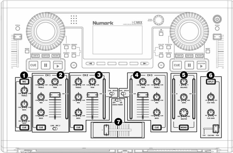
1. **CANAL DE MICRÓFONO** – Este canal incluye los siguientes controles de micrófono, que afectan a la señal de entrada Mic 1. Tenga en cuenta que la señal de micrófono no se aplica al crossfader y se envía directamente a la mezcla maestra.
