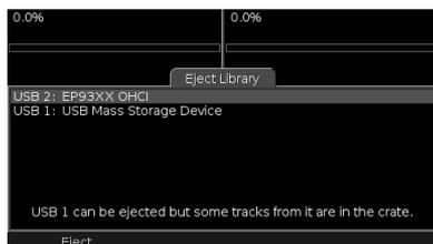
Per procedere con l'espulsione, selezionare **Eject** dal menu. Se vi sono tracce nel crate verrà chiesto di confermare l'operazione. Una volta che la libreria o le librerie di un determinato dispositivo sono state espulse e non sono più presenti nell'elenco, è sicuro rimuovere fisicamente il dispositivo. Se più di un dispositivo è collegato, bisogna prestare attenzione a rimuovere quello giusto!
