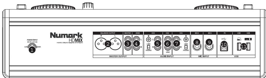
1. **Power** – Branchez l'adaptateur (c.c. 12 V 2 A) à cette entrée puis à une prise secteur. Veuillez utiliser l'adaptateur fourni *seulement*; l'utilisation d'un autre adaptateur pourrait endommager le HDMIX.
