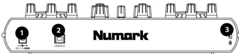
1. **AC IN** : Si l'appareil ne peut être alimenté pas le port USB, il peut être alimenté par un câble d'alimentation 6 V 1A c.c. branché à cette entrée.
