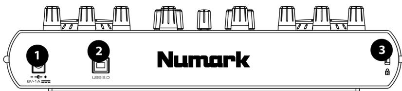
1. **Entrada de corriente alterna:** Si la unidad no se alimenta por la conexión USB, se puede alimentar enchufando un adaptador de alimentación de 6 V-1 A en esta entrada.
